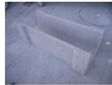
繊維成分配合、軽量・薄肉化ポーラスベッド 幅20cm、深さ20cm
