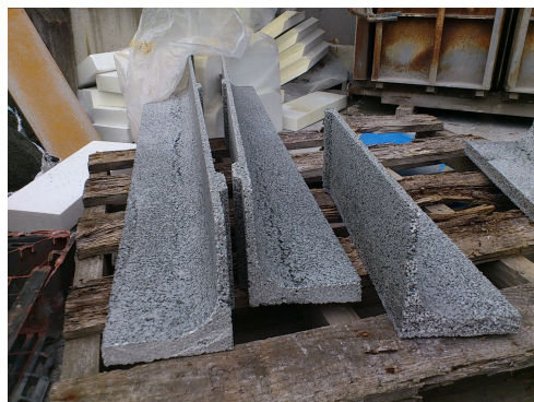
イチゴ高設栽培用L型分割隔離ベッド
