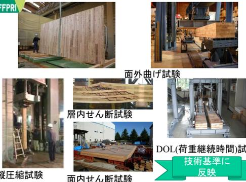
縦圧縮試験 面外曲げ試験 層内せん断試験 DOL(荷重継続時間)試験
