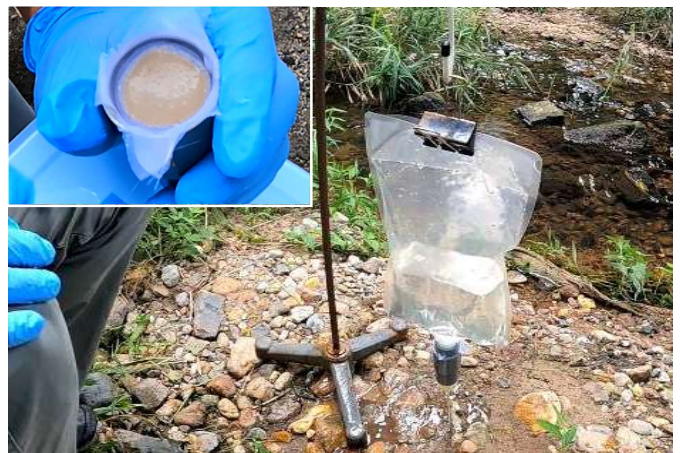
写真＝SGF法による環境DNAの濃縮・回収 （左上 ろ過アダプタで回収されたSGF）
