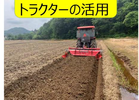
直進アシスト機能を使った耕起・溝切作業
