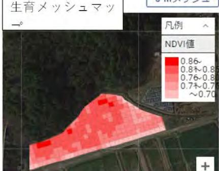
マルチスペクトルカメラ付きドローンを使用して、写真・NDVI・SRVI値を撮影・測定。KSASにより生育メッシュマップを作成し肥料の検討。写真画像からエゴマの生育と雑草の繁茂を調査する。
