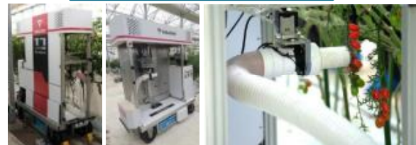
吸引型ミニトマト収穫ロボット「T7」（自社開発）
